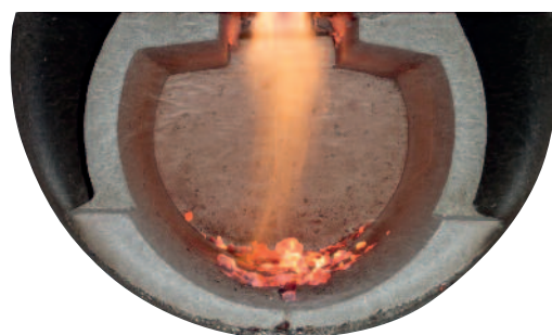
Горение газа в керамической топке T = 1000–1200 °C
